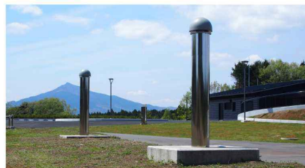
GNSS連続観測点
