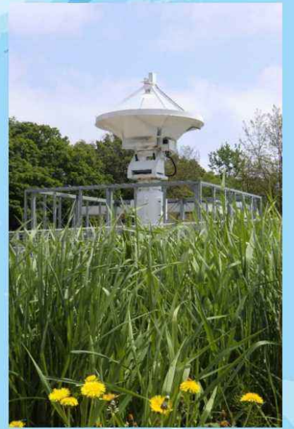
新十津川VLBI観測局(北海道) 完成: 1995年6月 アンテナ直径: 3.8m 駆動速度: 1°/秒 2013年12月運用終了
