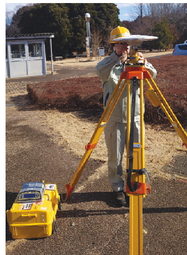
GNSS標高測量
