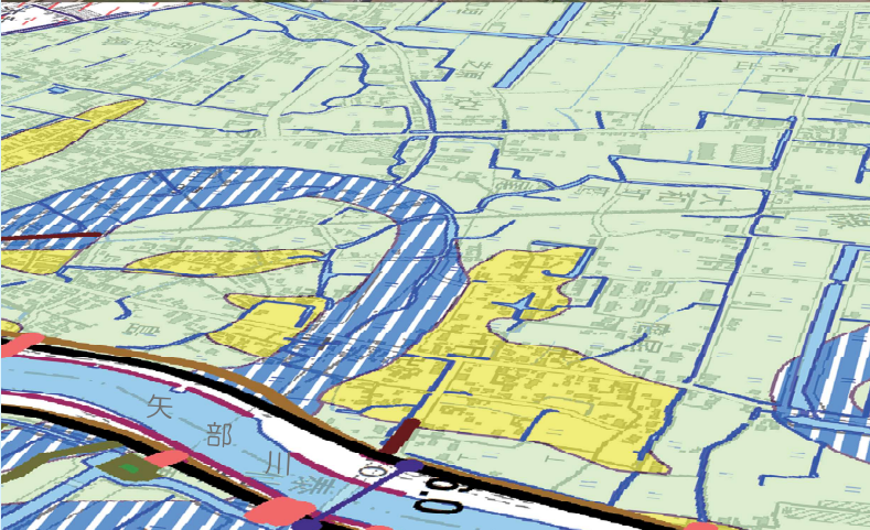
平成24年7月九州北部豪雨による浸水状況と治水地形分類図(朝川市大和町鷹ノ尾付近)
