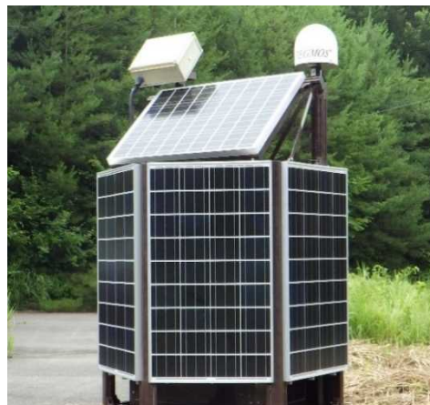
可搬型GNSS連続観測装置(REGMOS)
