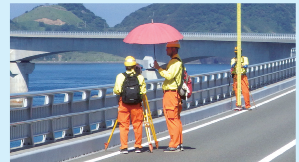
レベルを用いた水準測量
