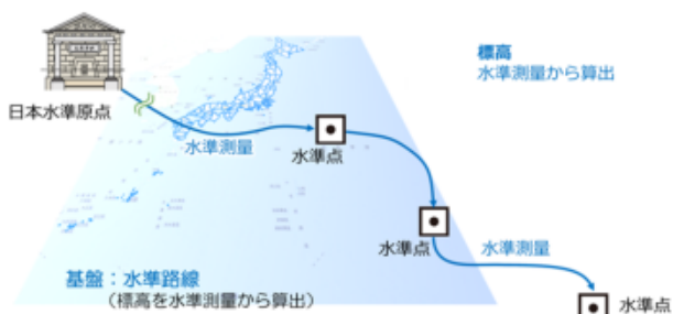
図-16 水準測量を基盤とする標高体系
