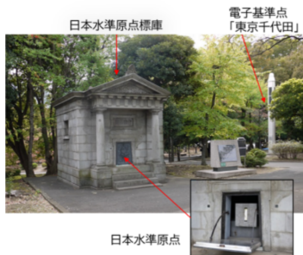
写真-1 日本水準原点と電子基準点「東京千代田」
