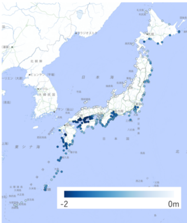
図-20 地形図の土地の高さと海図の海の深さの基準の違い。最低水面楕円体高は海上保安庁「平均水面、最高水面及び最低水面一覧表（令和6年8月30日現在）」を使用。図には最低水面楕円体高が整備されている地域のための基準の違いを表す。
