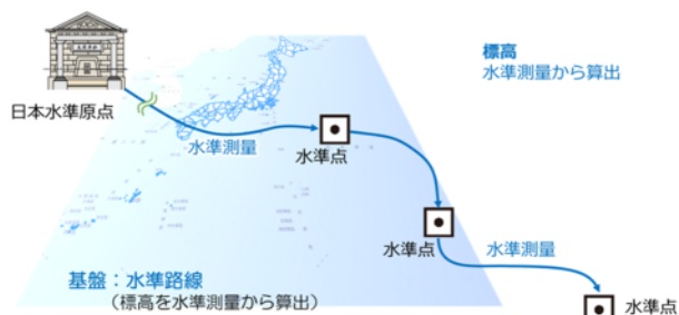
図-4 水準測量を基盤とする標高体系
