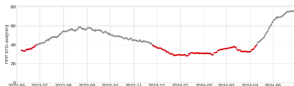
図-16 電子基準点「久喜」のPPPの標準偏差の時系列。灰色の点は標準偏差が40 mm以上の測位解を示す
