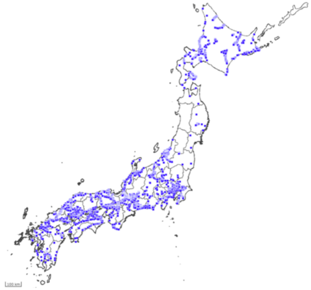
図-32 水準点標高補正パラメータによる改算の対象とした水準点
