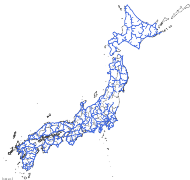
図-27 「2011 網平均計算+系変換による改算」の対象とした水準路線
