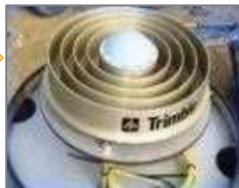
GNSSアンテナ
