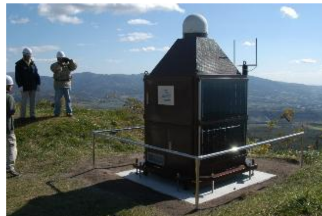
地盤の僅かな移動を検出するGPS観測システム
