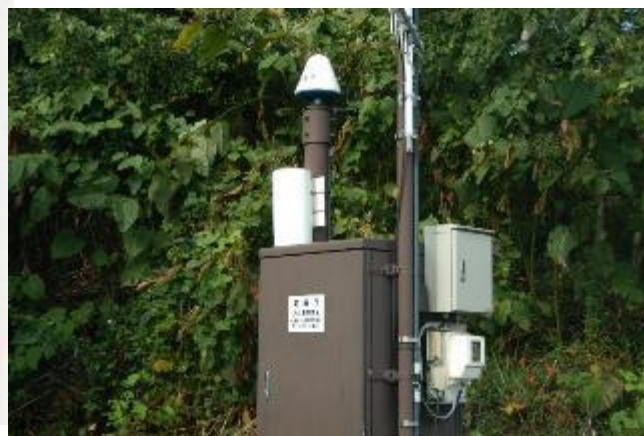
地盤の僅かな移動を検出するGPS観測システム
