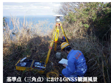
基準点（三角点）におけるGNSS観測風景
