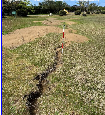
旧水部の盛土地・埋立地における液状化に伴う亀裂と噴砂 (令和6年4月25日 国土地理院撮影)
