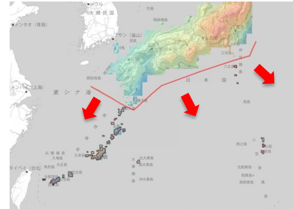
図2 基準面補正量計算が必要な範囲 (赤線より南の地域。吐噶喇(トカラ)列島以南、八丈島以南)
