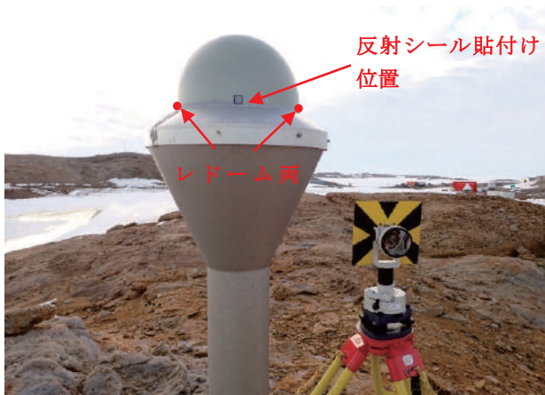
写真-7 各アンテナに貼付けた測量用反射シール （左：GNSS アンテナ，右：DORIS アンテナ）
