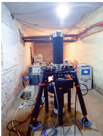
写真-1 ウランバートルの重力点での測定の様子
