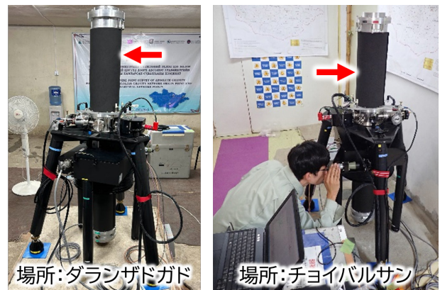
FG5 絶対重力計（矢印の部分が落下槽）
