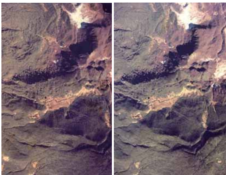
写真－16 剣岳溶岩円頂丘と地すべり性滑落崖 龍泉ヶ原北側では剣岳溶岩円頂丘の原面が残り、北西側や北側では溶岩円頂丘が地すべりのために崩落している （立体視可能, CT0-76-32 C20B 7-8）
