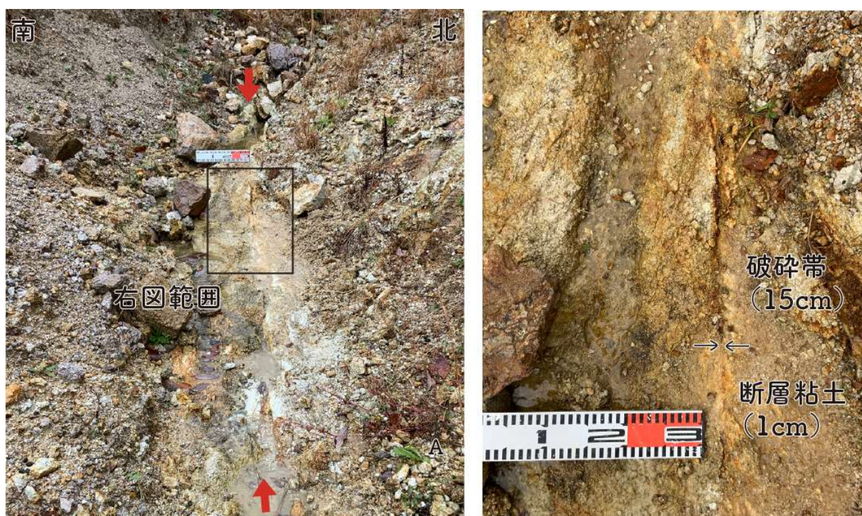
写真5 鳥取市滝山における滝山断層上の花崗岩内の断層粘土と破碎帯（2023年12月12日筆者撮影）。
