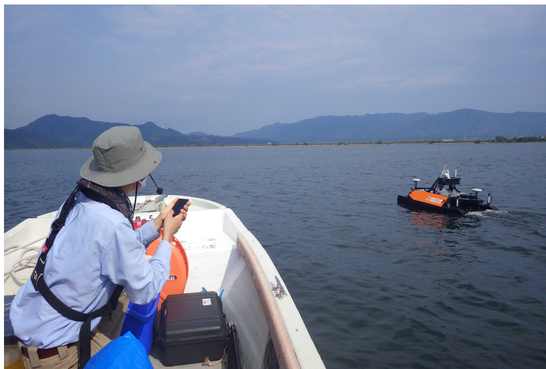
有人船並走によるUSV操縦イメージ（中海での調査）
