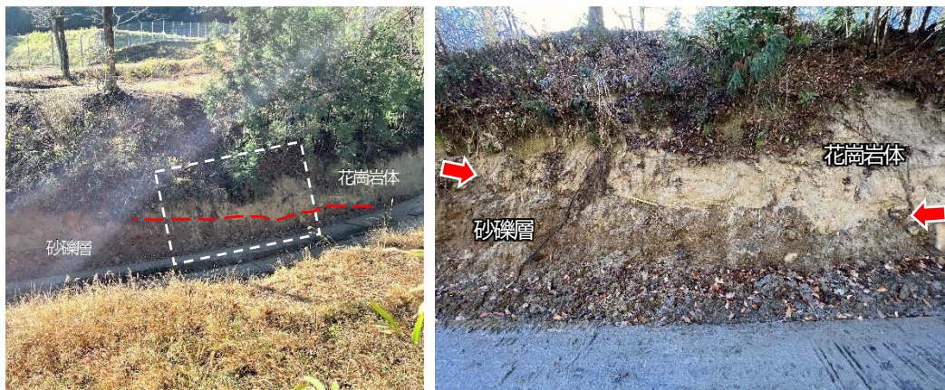
写真-8 戸沢右岸の下円井の断層露頭（2022年12月6日筆者撮影）。（左写真）戸沢の左岸から南西に向かって右岸側の露頭を撮影。調査時は戸沢の改修工事中であり、その工事用道路沿いに現れた露頭。赤破線が断層のおおよその位置、白破線枠は右写真のおおよその範囲。西側の花崗岩体が砂礫層に衝上している。この露頭の対面に既報の断層露頭がある。（右写真）左写真の露頭の拡大写真。南に向かって撮影。写真中央やや左の黄色の棒が長さ20cmの折尺。赤矢印の区間が活断層。
