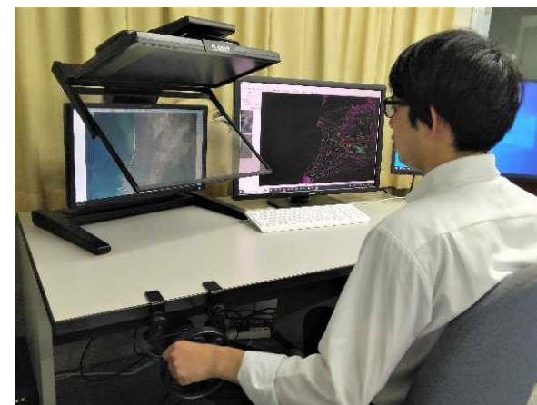
空中写真から海岸線、等高線などを図化
