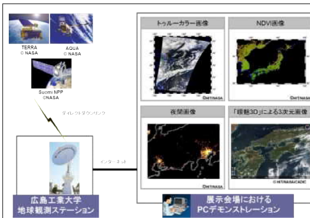
図1. 広島工業大学・地球観測衛星情報生成/配信システムの概要
