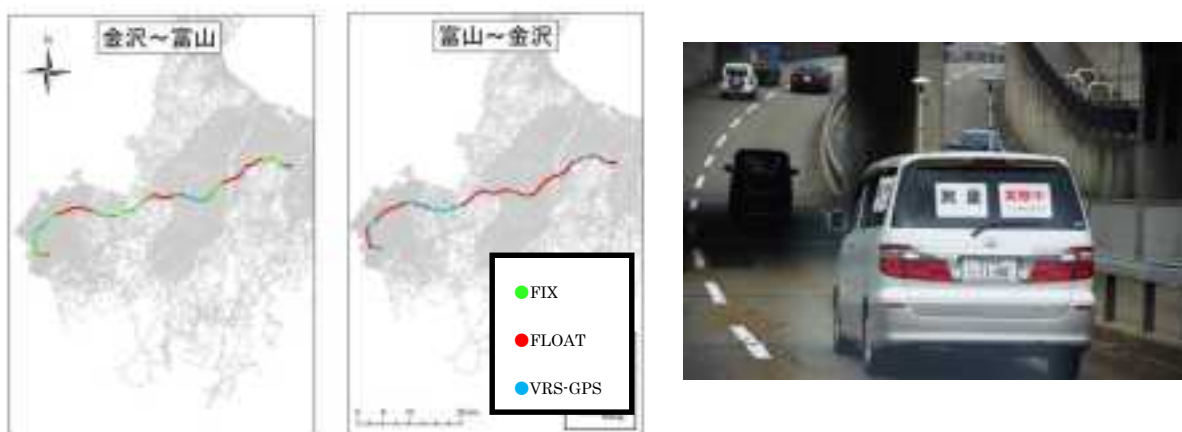
図 2 LEX 信号を使用した高速移動実験結果
