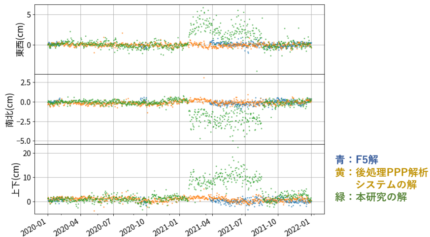
図-1 IGS 観測点 AIRA における F5 解, 後処理 PPP 解析システムの解及び本研究の解と, IGS 解との差の時系列. (青: F5 解, 黄: 後処理 PPP 解析システムの解, 緑: 本研究の解)
