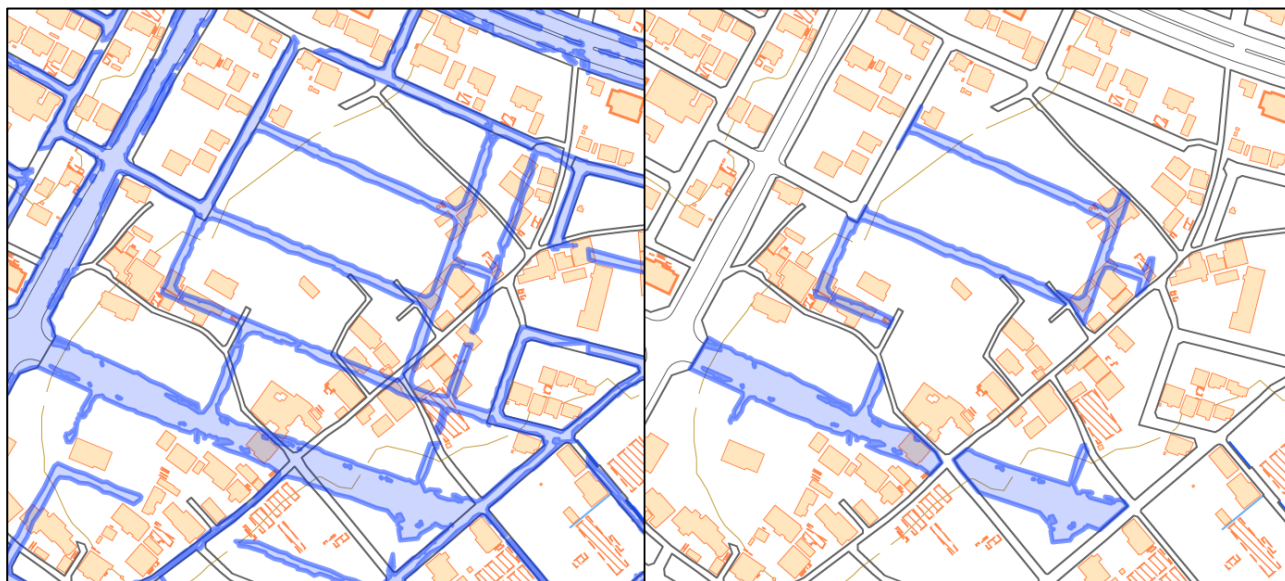
図-3 マージ後の自動図化結果（左図）を用いた，道路変化情報の自動抽出結果（右図）（CCB-2020-6）
