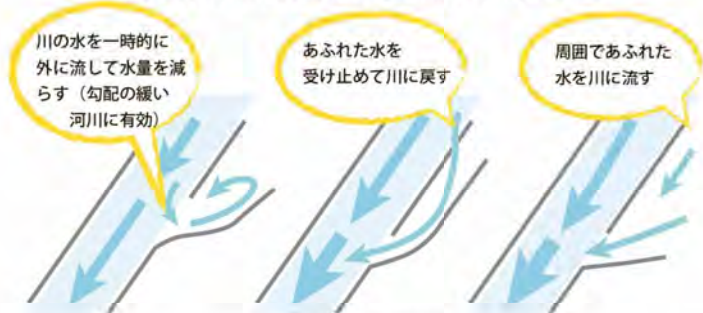
図 2-2 霞堤の仕組み
