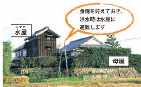
写真 2-5 現在も残る水屋建築 (国土交通省木曾川上流河川事務所の写真を編集) 「水屋建築」は輪中地域の代表的な建築です。洪水時に人命や財産を守るための建物で、母屋よりも高いところにつくられています。
