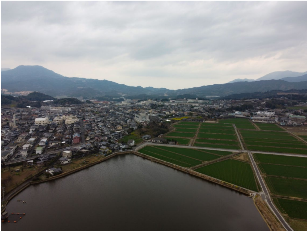
写真1 段丘を横切る多久断層の斜め写真 下位段丘面は人工改変により変動地形が解らなくなっている。 (2022年3月15日筆者撮影)
