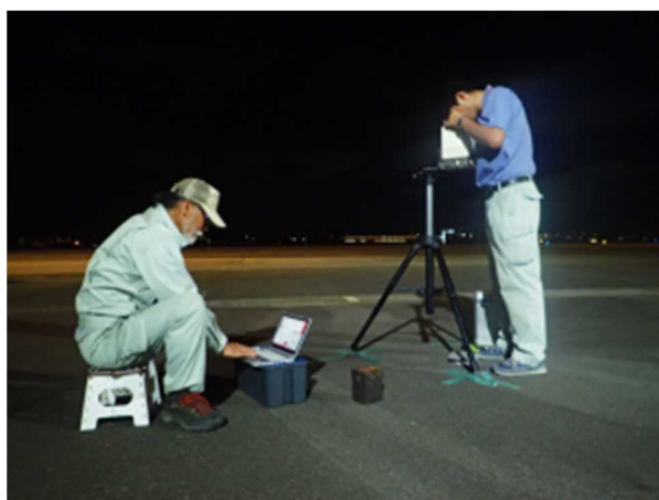
重力の鉛直勾配を測定している風景
