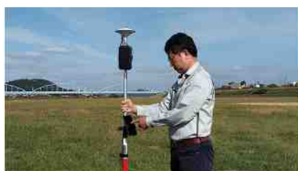
従来のTS(トータルステーション)を使った測量では、最低2人作業が必要なところ、単独での作業が可能に。
