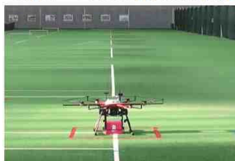
1m × 1mの枠内をターゲット (幅数cmの白線上にピンポイントで着陸)
