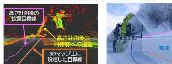
▲雪堤の高さに合わせた投雪位置の制御イメージ
