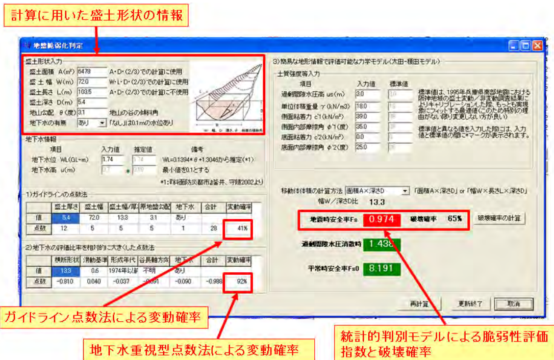
図 3-2-4 盛土個別の地盤脆弱性判定画面
