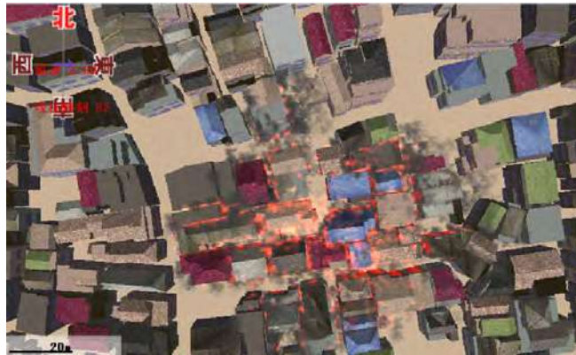
図 2-4-7 市街地火災シミュレーション結果の表示 (リアルモード)
