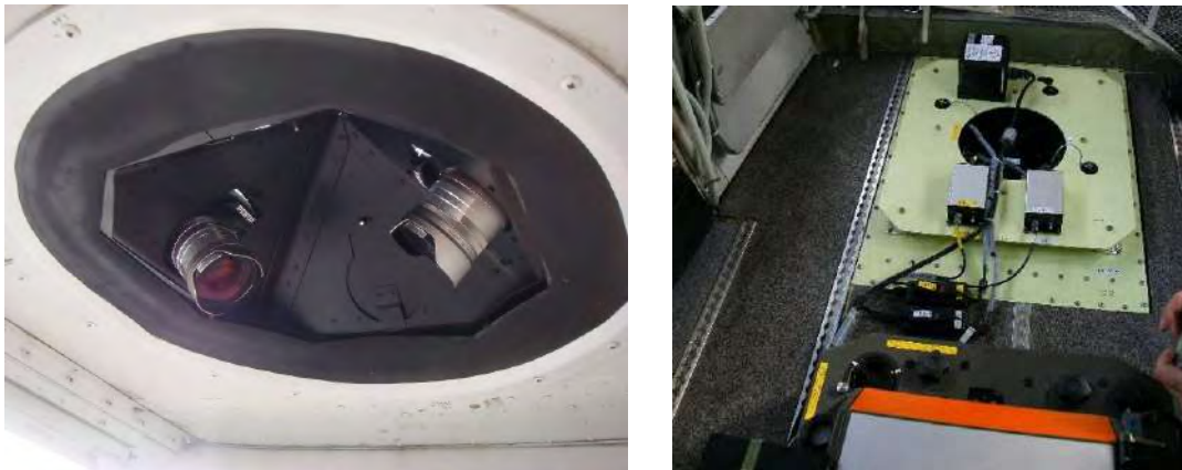
図－9 航空機への取り付け状況（左：機体外から見た底部、右：機体内部）
