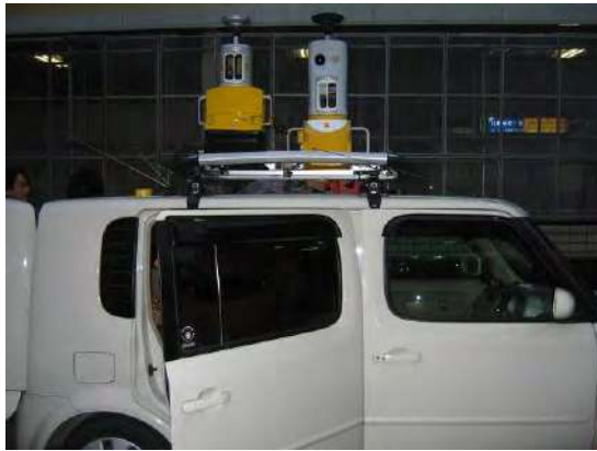
図－２ 車載されたレーザースキャナ（左）、取得される三次元データ（右）
