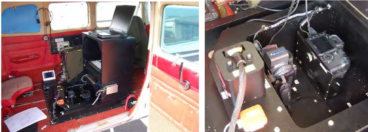
図-5 航空機への搭載の状況（市販のデジタルビデオカメラも同時搭載）
