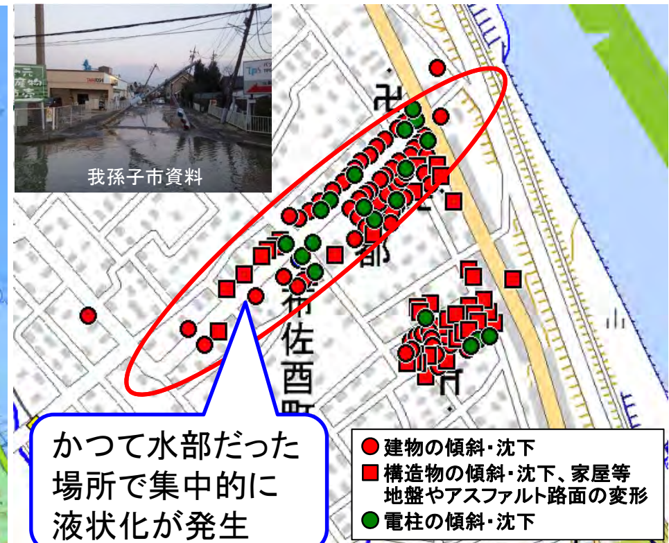
東日本大震災時の液状化の状況
