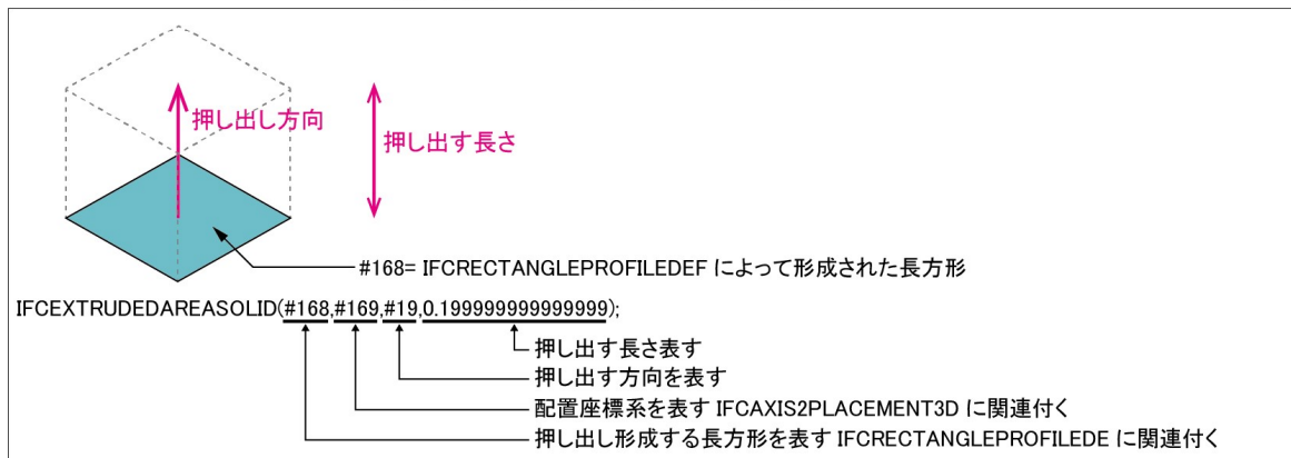
図－4 IFC による立方体の表現例
