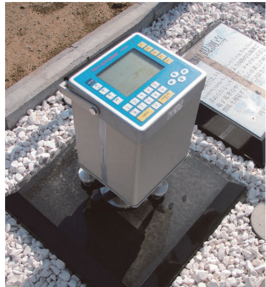
写真-4 CG5による測定風景
