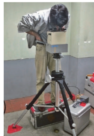
写真-2 ラコスト重力計による重力鉛直勾配の測定風景（2003年京都C）。重力点直上1.20mで観測。
