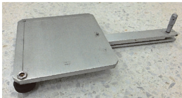
写真-5 ラコスト重力計検定台（アルミ製）。重力計を載せる台（左）及び傾斜台（右、先端はマイクロメーター）。傾斜台は分離が可能。
