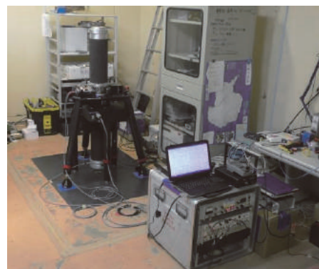
写真-5 昭和基地 FGS における FG5 絶対重力計 (#203) による測定風景 (第 56 次観測隊撮影)。
