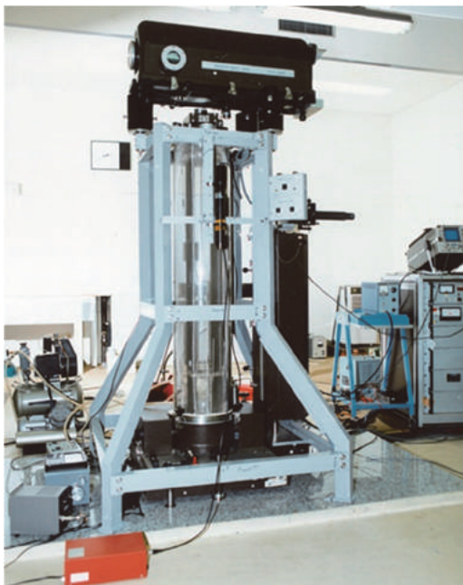
写真-7 GA60 型絶対重力計（撮影年不明、国土地理院重力測定棟地下1階）
