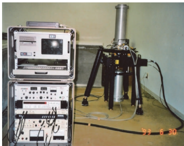
写真-8 導入直後の FG5 絶対重力計#104
