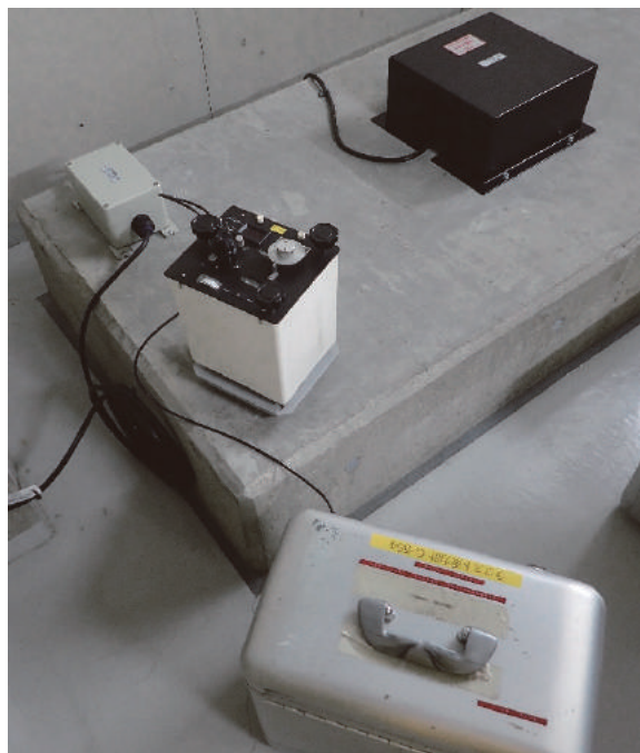
写真-4 ラコスト重力計(G-554, 1980年購入, 中央)とキャリングケース(手前)。2015年10月、一等重力点「旭川」(旭川地方気象台地震計室の基台)で撮影(右奥は地震計)。
