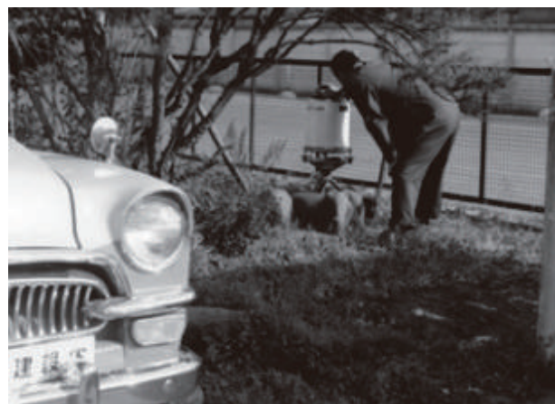
写真-2 AG1 重力計による重力測量
