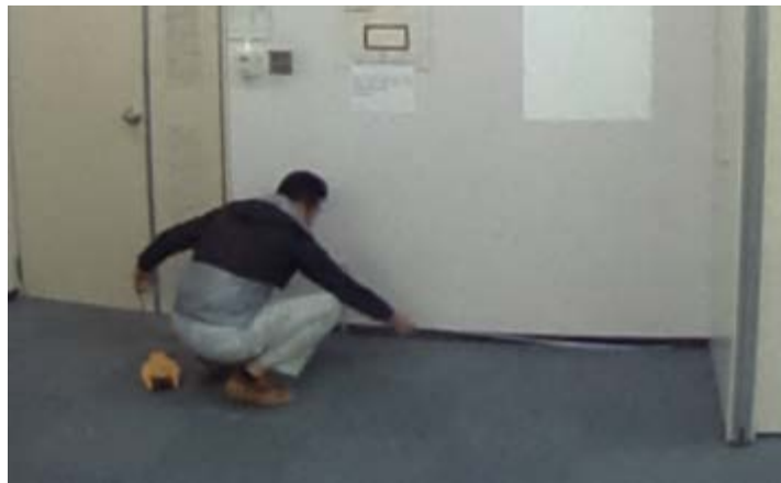
図 3-13 巻き尺で計測する例
