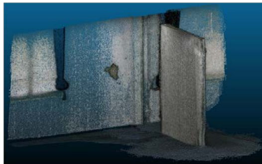
距離センサ付きスマートフォンによるSLAM(Google Tango)
