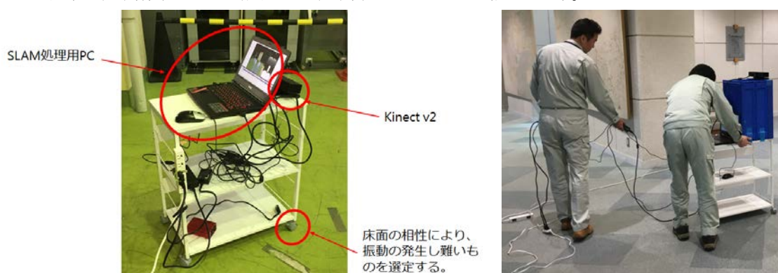
図 3-11 距離センサ(Microsoft Kinect v2)の台車使用例及び計測風景
