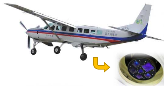
くにかぜIIIと下から見た航空カメラ（拡大） ※撮影しないときには窓穴を閉めています
