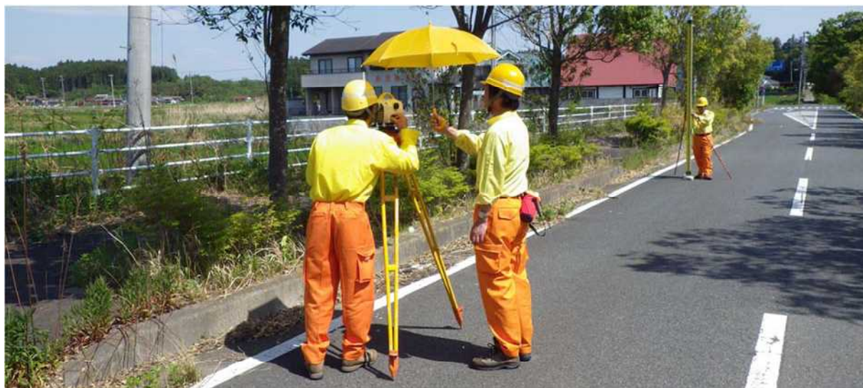
高さを正確にはかる水準測量の様子
