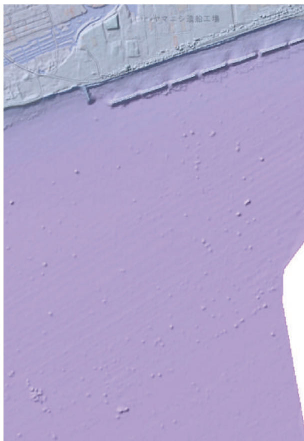
図-14 石巻市西浜町沖の段彩陰影図。 震災瓦礫と思われる影が沖合に点々と見える。（斜め方向の薄い縞はマルチビーム音響測深のノイズによるもの）
