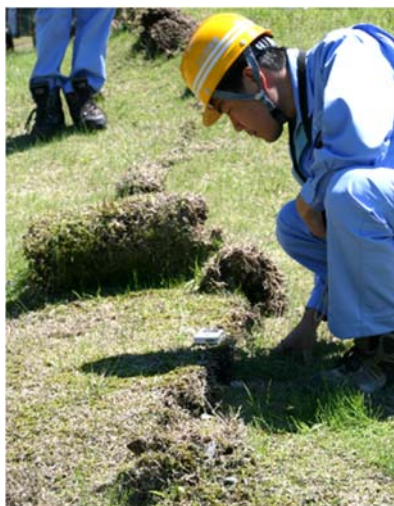
断層の走向計測 断層モデルを作る
