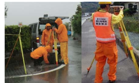
緊急地殻変動観測 地震による地盤の沈下・隆起の全体像を把握
