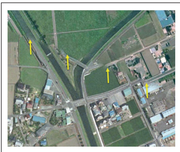
図-12 コース間に GCP が配置されない際に生じやすい不整合
