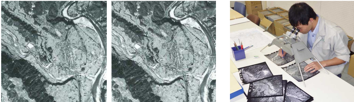
図－5 阿寺断層（中津川市坂下付近）の空中写真と写真判読
