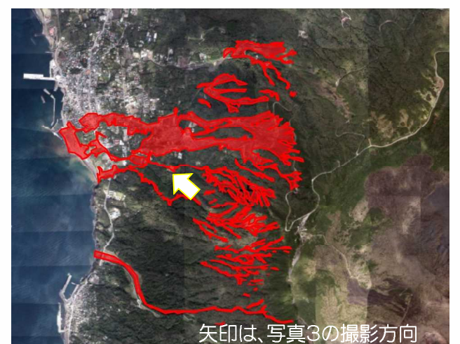
写真2 台風26号による土砂流出範囲
