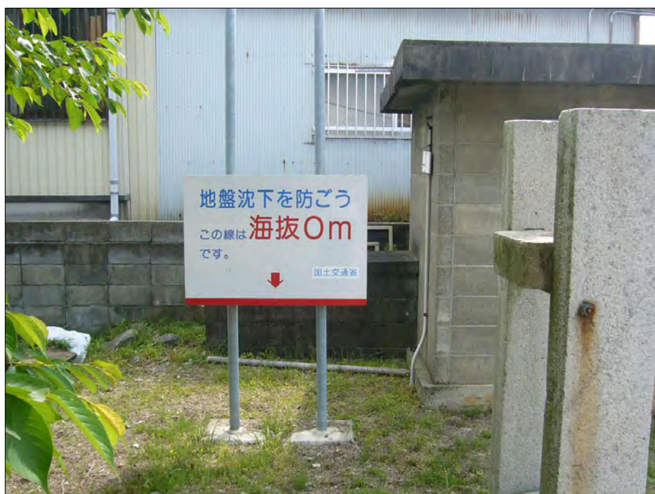
写真一6 三重県桑名市福岡町 神明神社の海水面レベルの表示 (平成23年5月撮影)
