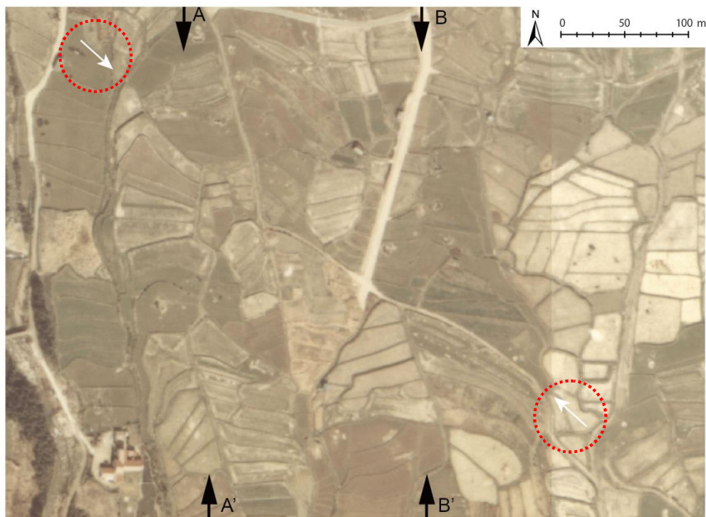
写真 3 早良区脇山における圃場整備以前の空中写真に見る低断層崖 国土地理院 1974 年撮影の空中写真から作成したオルソ写真。 白矢印は断層線を示す。黒は図 7 の地形断面図の測線。
