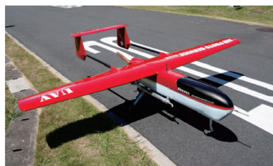
写真-12 基準点「通信」上の UAV。UAV 付属の GPS アンテナが基準点の真上に来るようにし、GPS 測位データを計測・記録している。離陸前と着陸後の 2 回測位を実施。
