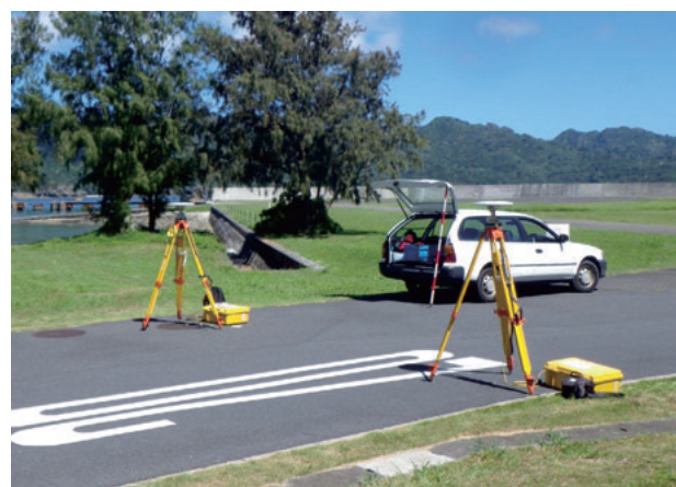
写真-11 離陸前に測地部南硫黄島観測班が実施した 2 つの基準点上の GNSS スタティック測位。既存の「通信」と記された基準点（右手前）を、UAV の位置補正のために使用した。
