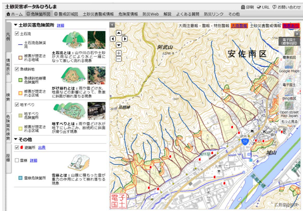
図5 広島県の土砂災害危険箇所マップ（八木地区周辺）
