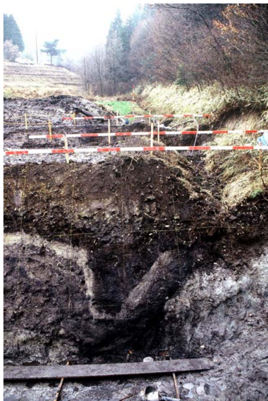
写真 7 中津川市伝田原トレンチで見られた地層の変位（1993年12月岡田篤正撮影）
