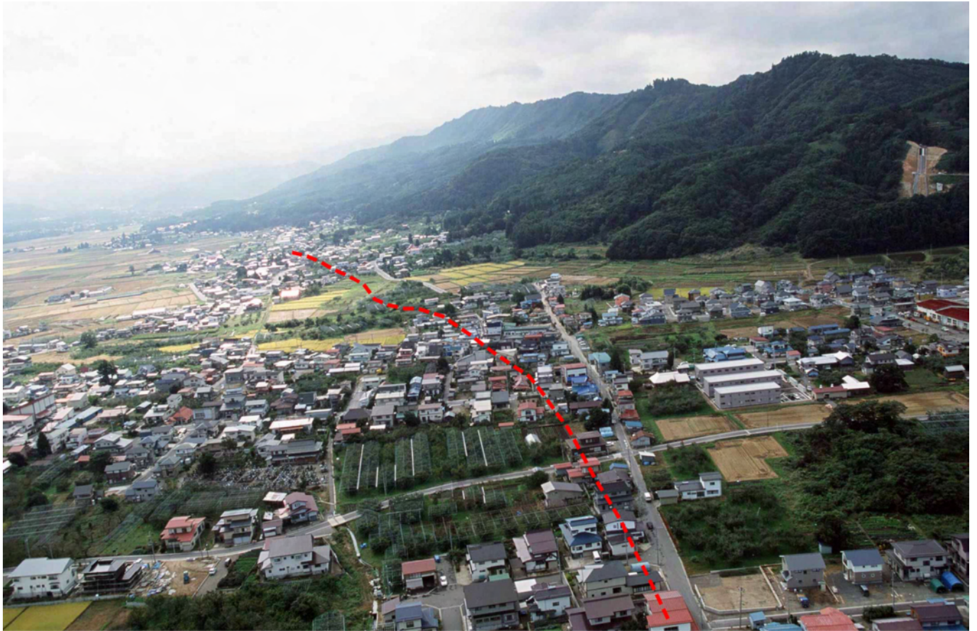
写真6 米沢市街西方・館山から笹野山方向に連続する撓曲地形と断層崖（赤破線）。（八木浩司撮影）
