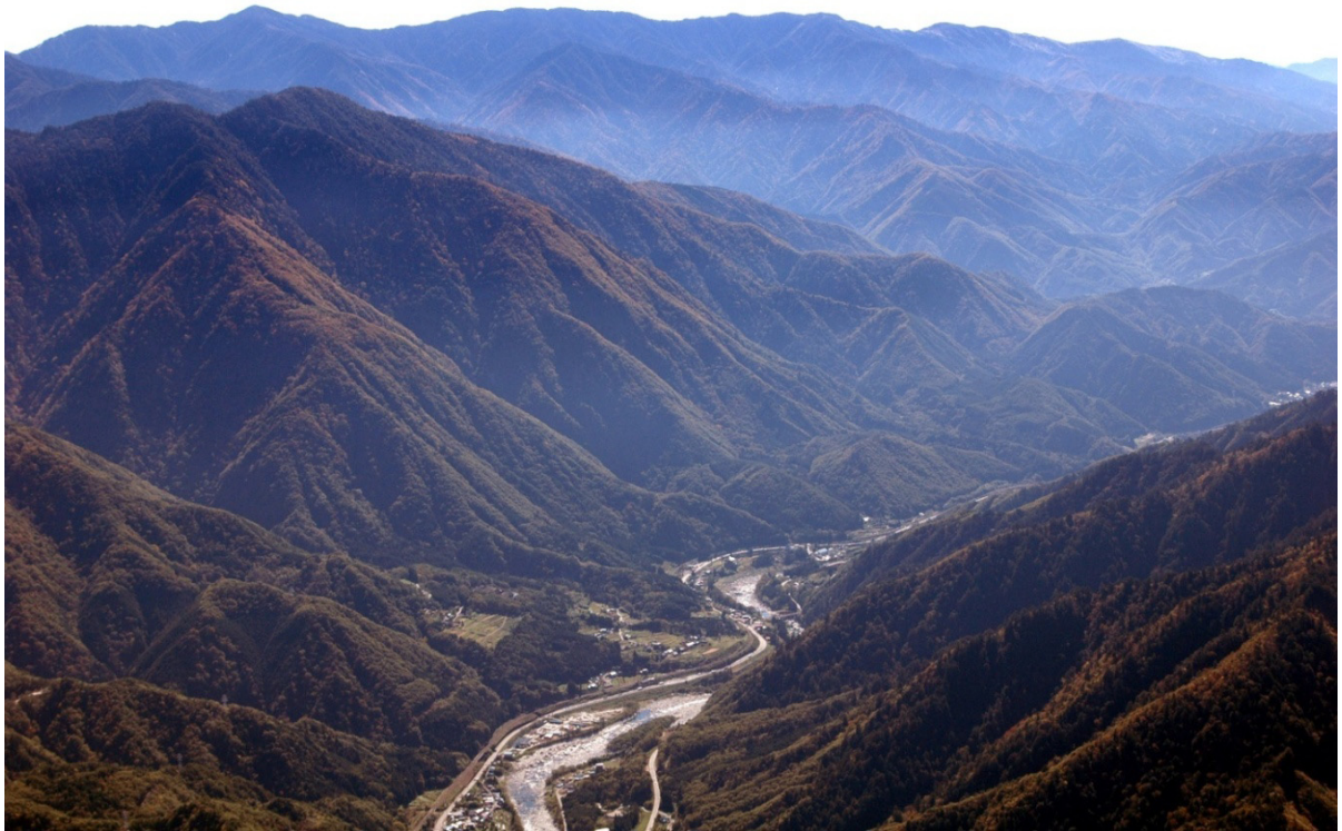
写真5 上松町南方の倉本付近から大桑村須原東方付近にかけての木曽山脈西縁断層帯（上松東断層）を南望。上松東断層は倉本（中央下）の段丘面群を変位させ、鞍部地形を伴って南方に連続する（2006年10月岡田篤正撮影）。
